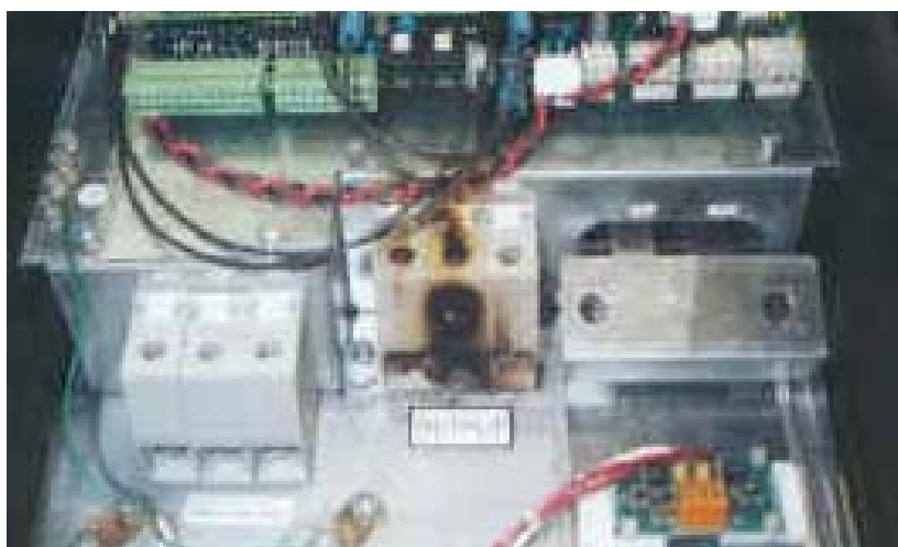
ภาพตัวอย่าง ผลของการเกิดการอาร์ค เนื่องจากหน้าสัมผัสทางด้านเอาต์พุตหลวม
