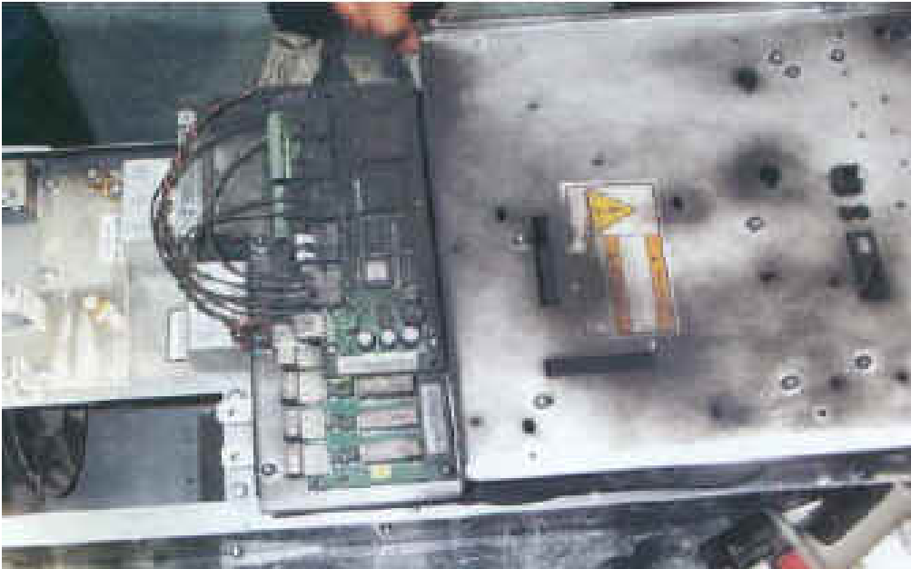
รูปแสดงตัวอย่างอินเวอร์เตอร์ที่ได้รับความเสียหายฝุ่นที่พัดลมระบายความร้อนที่เป่าเข้ามา
