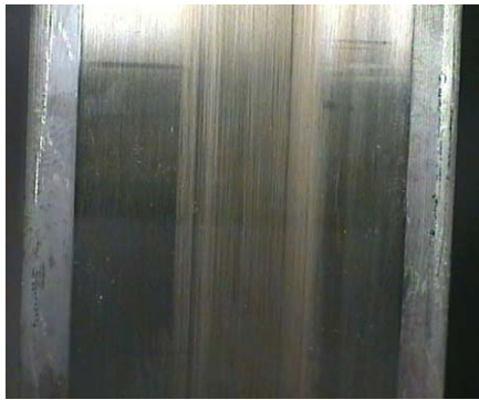
รูปที่ 11 ภาพแสดงแหวนรองลื่นมอเตอร์เสียหายอันเนื่องมาจากกระแสไหลผ่าน
