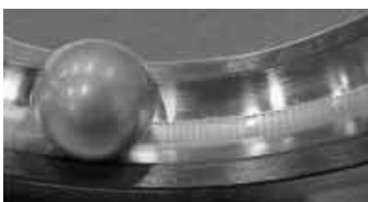
รูปที่ 11 ภาพแสดงแหวนรองลื่นมอเตอร์เสียหายอันเนื่องมาจากกระแสไหลผ่าน
