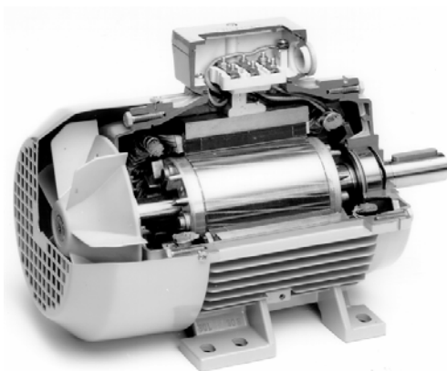
รูปที่ 2 แสดงลักษณะโครงสร้างของมอเตอร์เหนี่ยวนำแบบกรงกระรอก
